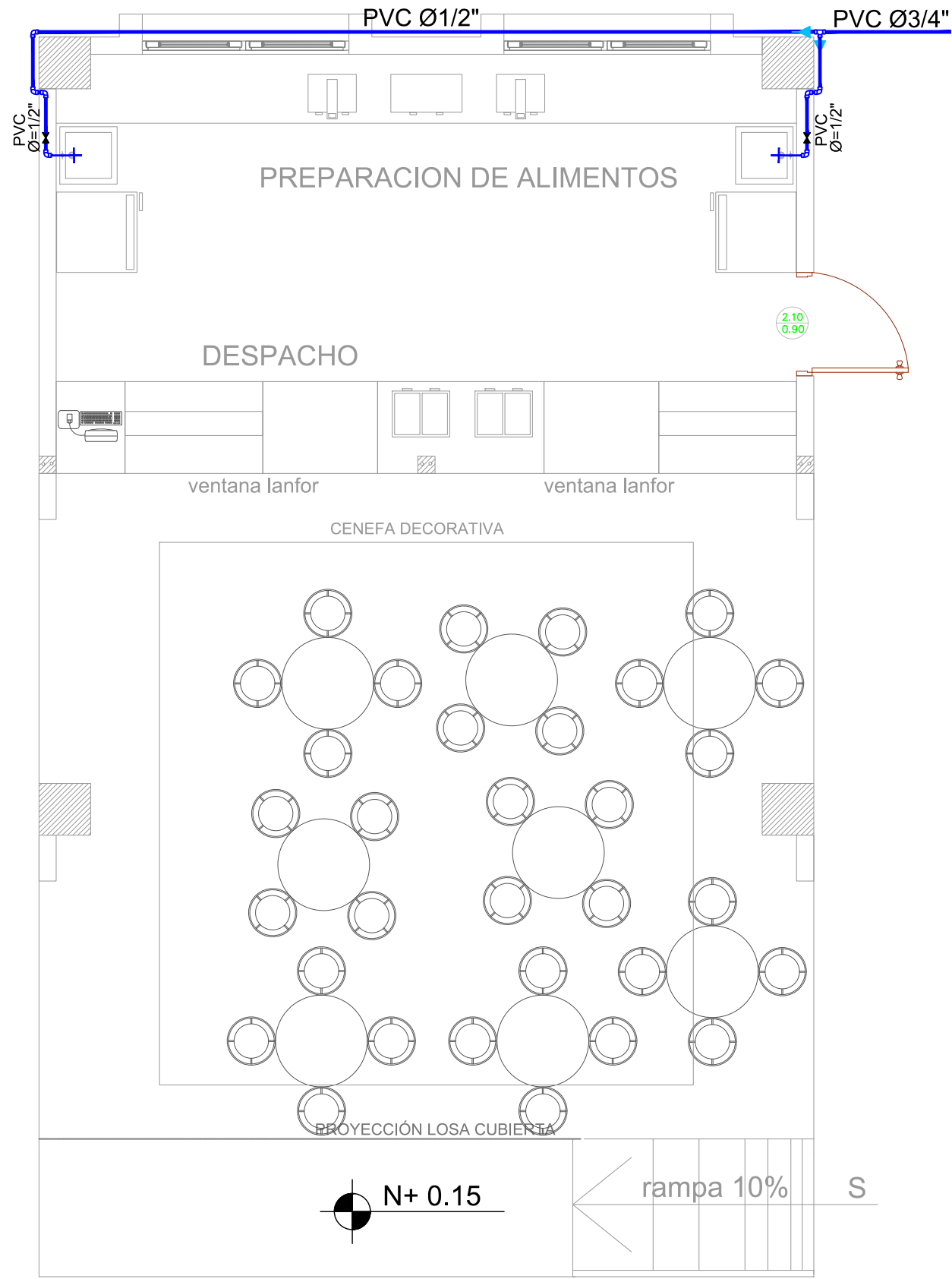
UBICACIÓN DE TUBERIAS DE AGUA POTABLE
